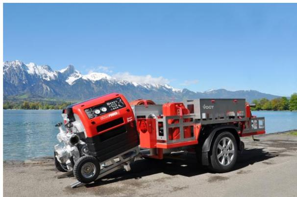
Rampes de chargement en acier inoxydable, double arrêtoir avec levier de serrage pour des manœuvres de chargement et déchargement de la motopompe réalisables par une seule personne.
