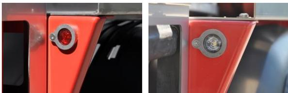
Le câblage est en majeure partie caché dans la structure métallique et est relié à une boîte de distribution sous le plateau. Les feux de position sont intégrés directement au châssis. Feux arrière (LED), protégés par les cadres de loquettes à tuyaux. La connexion électrique avec le véhicule tracteur est faite par prise à 13 pôles.
