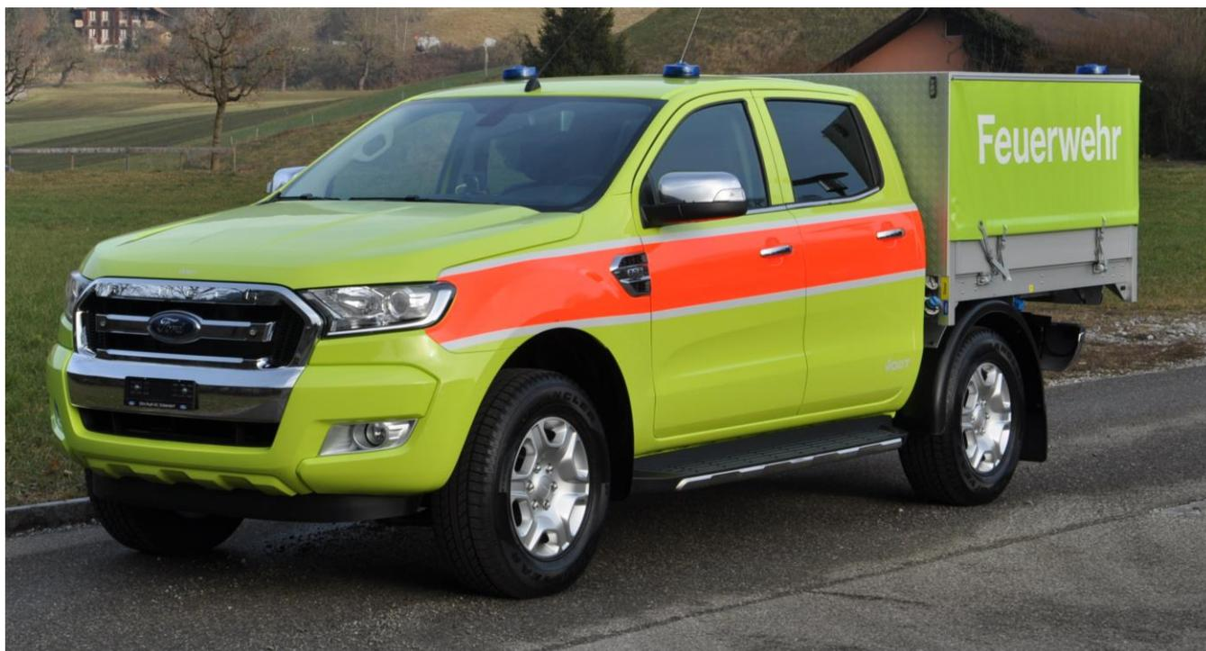
– Aluminiumbrücke mit Blachenaufbau
